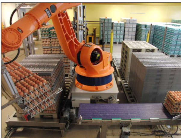
Depalettierung mit Fördersystem und Ausrichtstation
