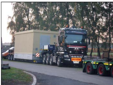
Anlieferung einer Betonstation
